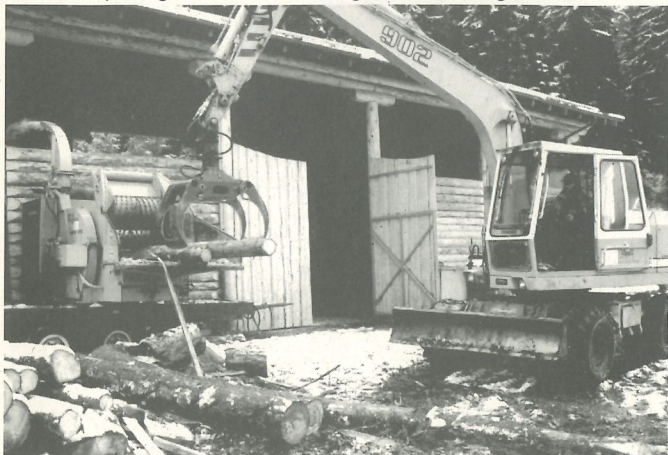
Le déchiquetage du bois au hangar de stockage.
